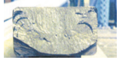
Bruchfläche mit Weißeinstrahlung
