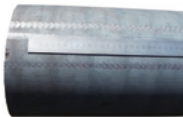
Markierungen der Zieheinrichtung parallel beidseits des Stahlmaßstabs
