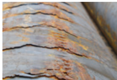
Ziehschrittüberlappung an einem runden Halbzeug
