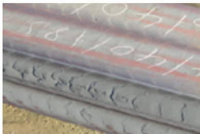
Ziehschrittüberlappungen an einem rechteckigen Halbzeug
